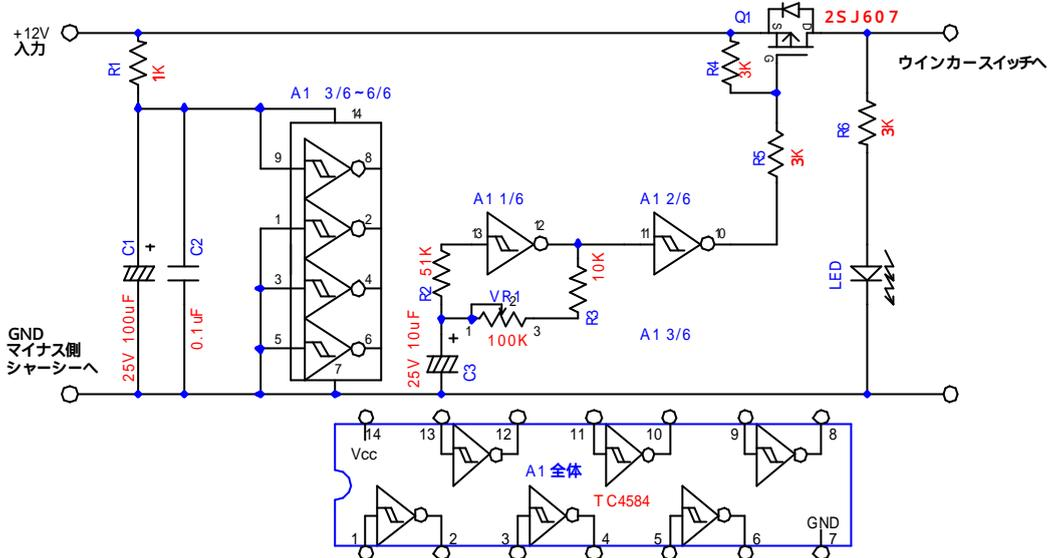
点灯時間計算式 点灯時間 =  $0.755 \times C \times (VR + R3)$  (秒)
