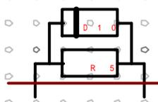
黒線 0.6mm ツギ線 で最初に配線する。
